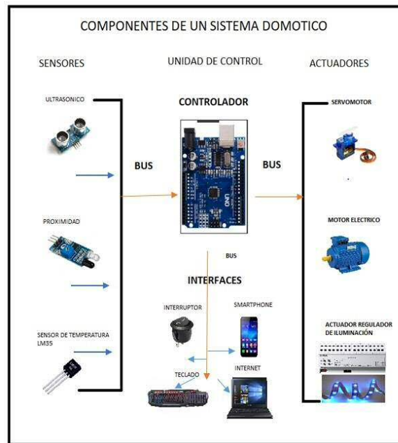
Fig. 1. Componentes de un sistema domótico.
